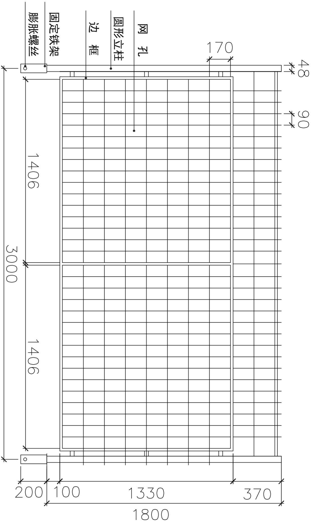
注明: 立柱 (圆形) :  $\phi$ 48mm、网孔
